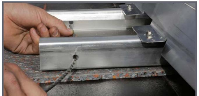
Seilführung durch die Bodenschienen
