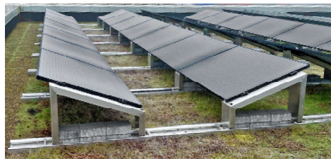
Système de montage GR-EW Angle d'inclinaison de 10° / 15° / 20° Orientation est-ouest
