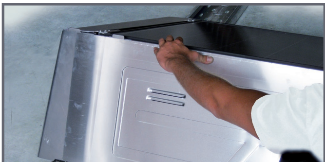
Accrochage de la tôle de protection contre le vent
