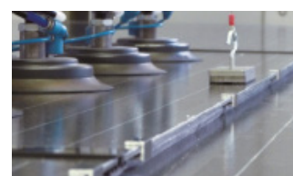
Test de charge sur modules photovoltaïques
