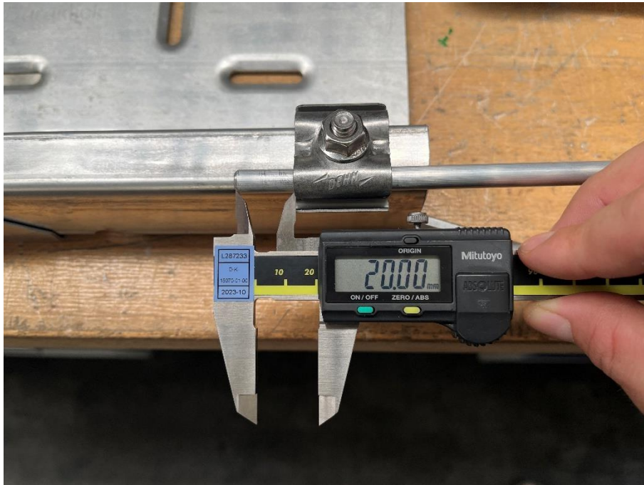
Bild 19: Messung der Leiterlänge nach Verbinder – Uni - Erdungsklemme 1.
