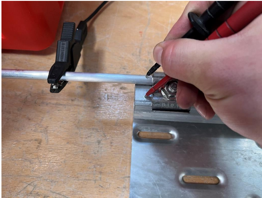
Bild 23: Messung Übergangswiderstand – Duraklick Bodenschiene über Uni – Erdungsklemme 2 zu Runddraht Alu 8mm.
