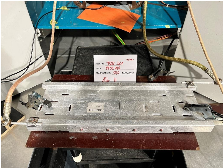
Bild 13: Prüfmuster TS02 S01 nach der Belastung mit 3x 50 kA (10/350 µs).
