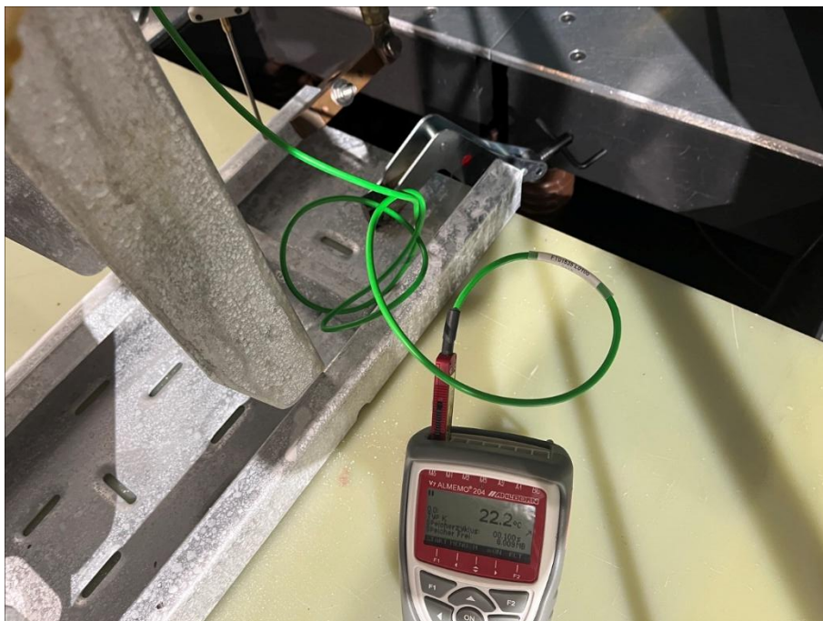
Bild 15: Temperaturmessung am Verbindungsbauteil Leiter 2.
