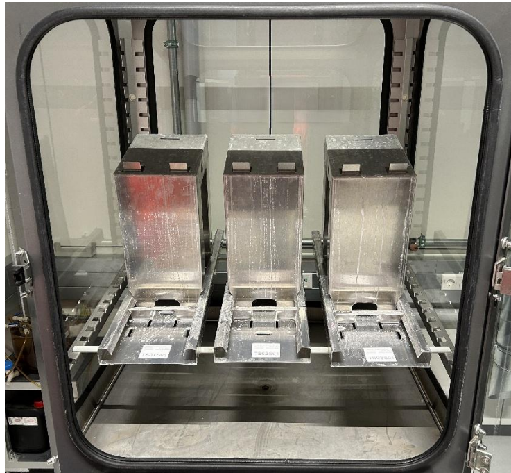
Bild 4: Prüfmuster im Gerät für feuchte schwefelige Atmosphäre.
