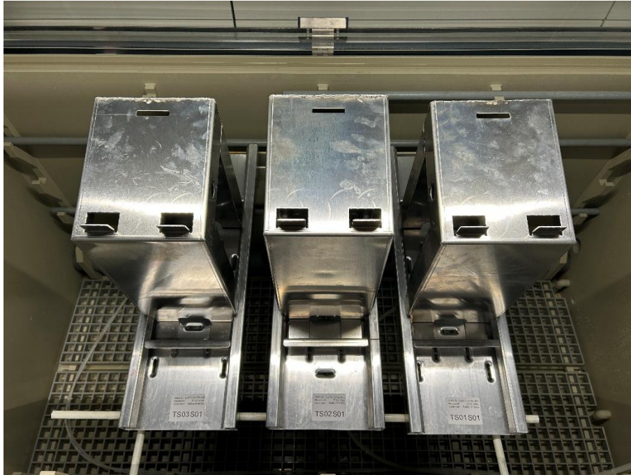
Bild 2: Prüfmuster in der Salzsprühtruhe.
