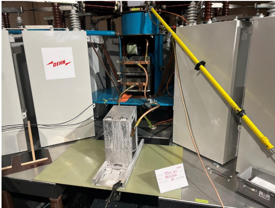
Bild 8: Prüfmuster TS01 S01 vor der Belastung mit 3x 50 kA (10/350 µs).
