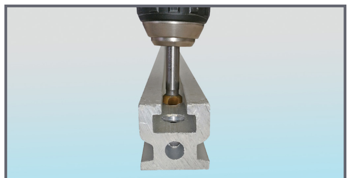
... Löcher innen senken mit Spezialsenker
