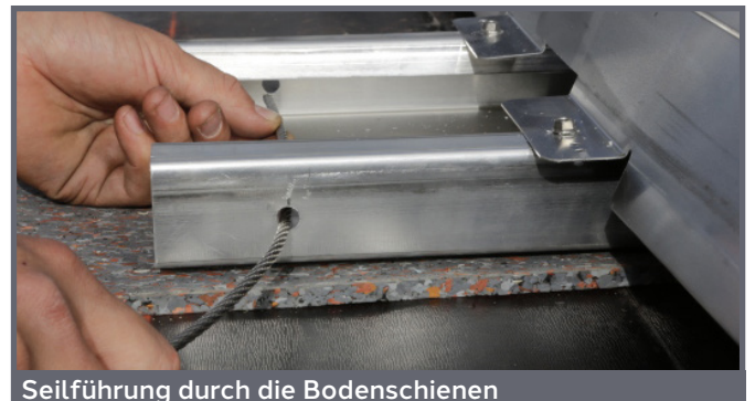
Seilführung durch die Bodenschienen
