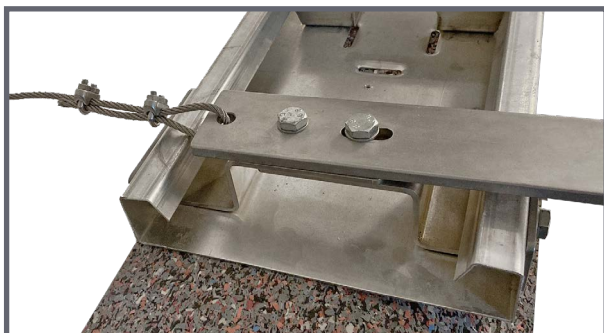
Position des Drahtseils am Ausleger
