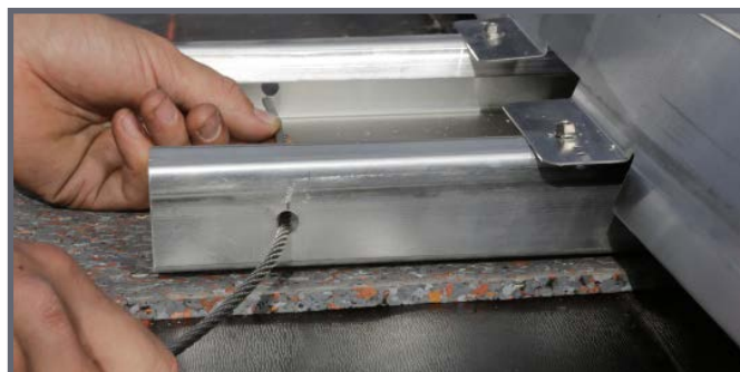
Guidage du câble par les rails au sol
