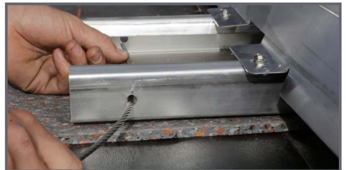
Seilführung durch die Bodenschienen
