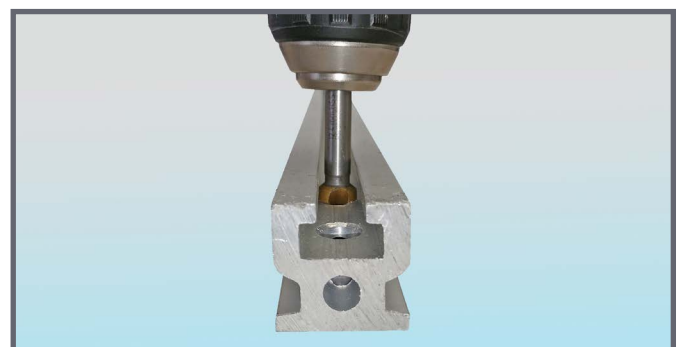
... Löcher innen senken mit Spezialsenker
