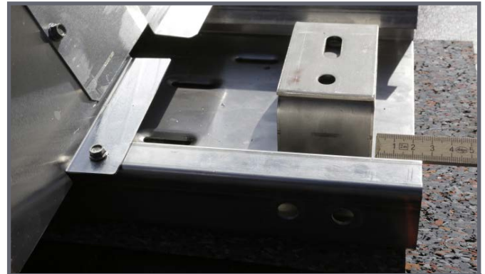
Abstand von min. 20 mm zum Bodenschienen-Ende
