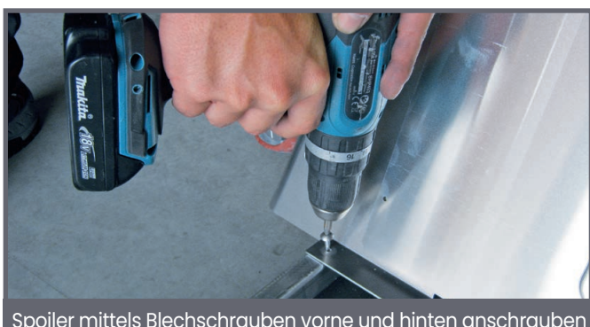
Spoiler mittels Blechschrauben vorne und hinten anschrauben
